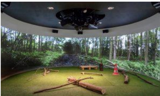
Die Vortalis „MonoCurve“, basierend auf sechs LED-1-Chip-Projektoren, vermittelt eine enorm realistische Umgebung, da sie die Bilder in einem realen Maßstab von 1:1 wiedergibt und durch ihre gebogene Form den Anwender nahezu gänzlich umgibt.
