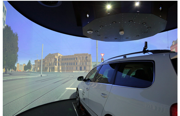
DLR - VR LAB - 360° hi-res Zylinderprojektion mit VW FASCar zur Evaluation von Fahrerassistenzsystemen
