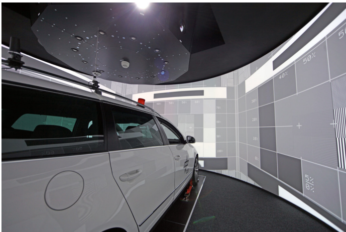
DLR - VR LAB - 360° hi-res Zylinderprojektion mit VW FASCar zur Evaluation von Fahrerassistenzsystemen - während Kalibration
